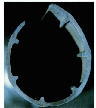
破壊状態 (103MPaで破壊)
